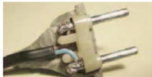
Отремонтировать неразборную вилку с обрывом провода в месте соединения с ней можно простым способом. Надо разрезать вилку по плоскости шире, удалить остатки провода и припаять свежечачищенные концы. Затем склеить вилку и наложить ниточный бандаж.
